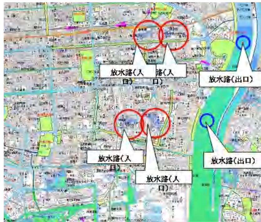
左の高潮シミュレーションに放水路を設定してシミュレーションした例
